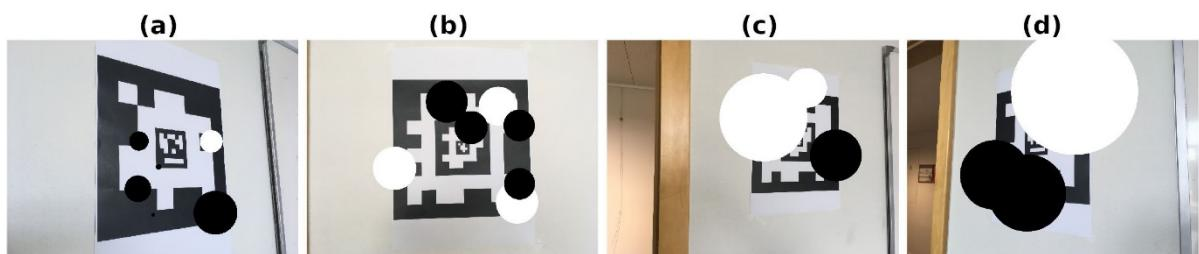
Slika 13: Neke su slike korištene za testiranje detekcije uz zaklanjanje. Sintetički se na slike primjenjuju različite razine zaklanjanja: (a) 11.29%, (b) 33.19%, (c) 53.92%, (d) 73.37%. [12]
