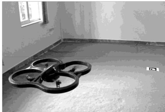
Slika 16: Kvadrotor AR.Drone 2.0 koji se kreće prema Aruco markeru u laboratorijskim uvjetima. [21]
