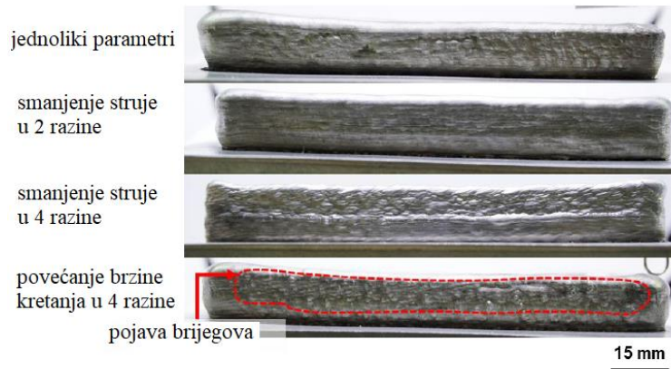
Slika 4.44. Izrađeni zidovi s 20 slojeva – DP MIG proces, [52]
