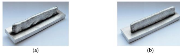
Slika 5.2. Izrađeni zidovi: a) Al-4047, b) Al-5356, [60]
