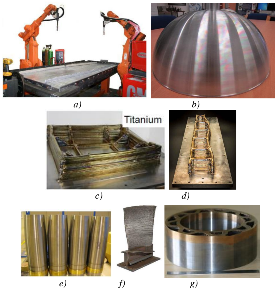
a) Aluminijsko rebro krila aviona, [38] b) Aluminijska kupola tanka goriva, [39] c) Složeni profil titanove zrakoplovne komponente [40] d) Dio zrakoplovnog krila od titanove legure, [39] e) Čahure granate od nehrđajućeg čelika [6] f) Čelična turbinska lopatica [6] g) Dio izrađen od raznorodnih materijala čelik/bronca [6]
