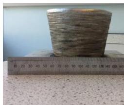
Slika 4.9. Cilindrični i konični profili zida, [39]
