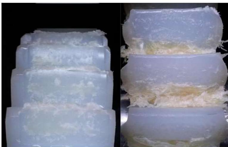
Slika 3.36. Stanje površine boka zuba pogonskog i gonjenog PA 6 zupčanika nakon izvršenih 3 milijuna ciklusa ispitivanja [59]
