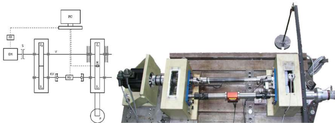
Slika 4.2. Uređaj za ispitivanje polimernih zupčanika sa zatvorenim tokom snage [59]
