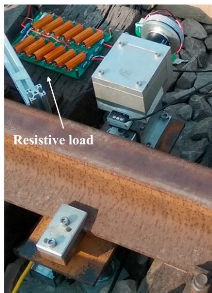
Slika 3.50 Postav terenskog ispitivanja uređaja [51]
