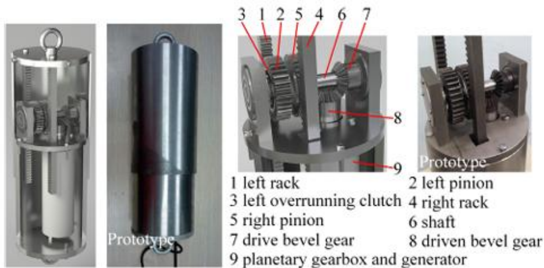
Slika 3.4 3D CAD model i izrađeni prototip regenerativnog apsorbera [7]
