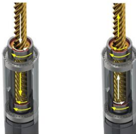
Slika 3.3 Pretvorba dvosmjernog pravocrtnog gibanja u jednosmjerno rotacijsko [6]
