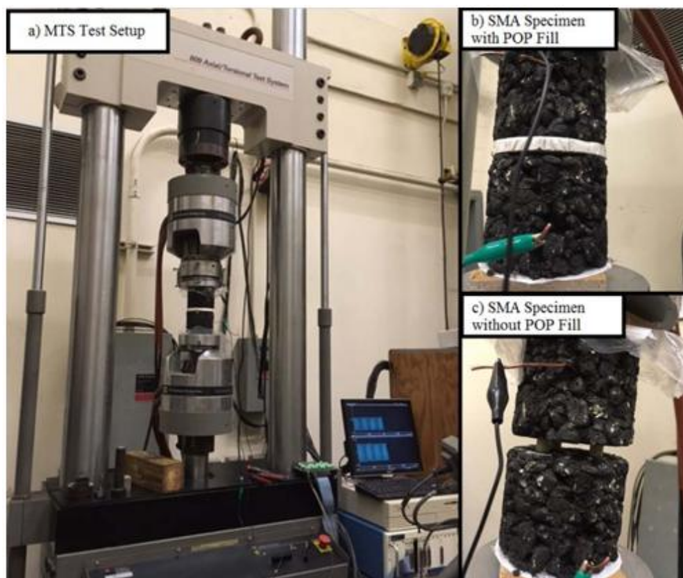
Slika 3.81 Eksperimentalni postav predloženog sustava [77]
