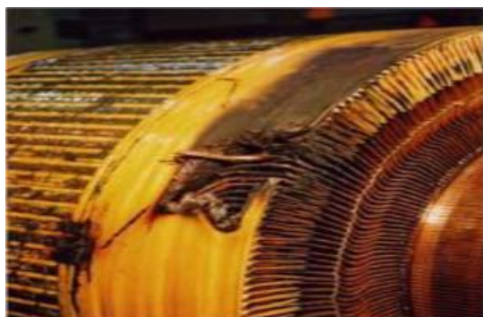
Slika 2.5 Pogreške u namotima (a) motora i (b) hidrogenatora
