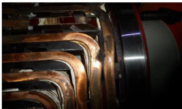
Slika 2.5 Pogreške u namotima (a) motora i (b) hidrogenatora
