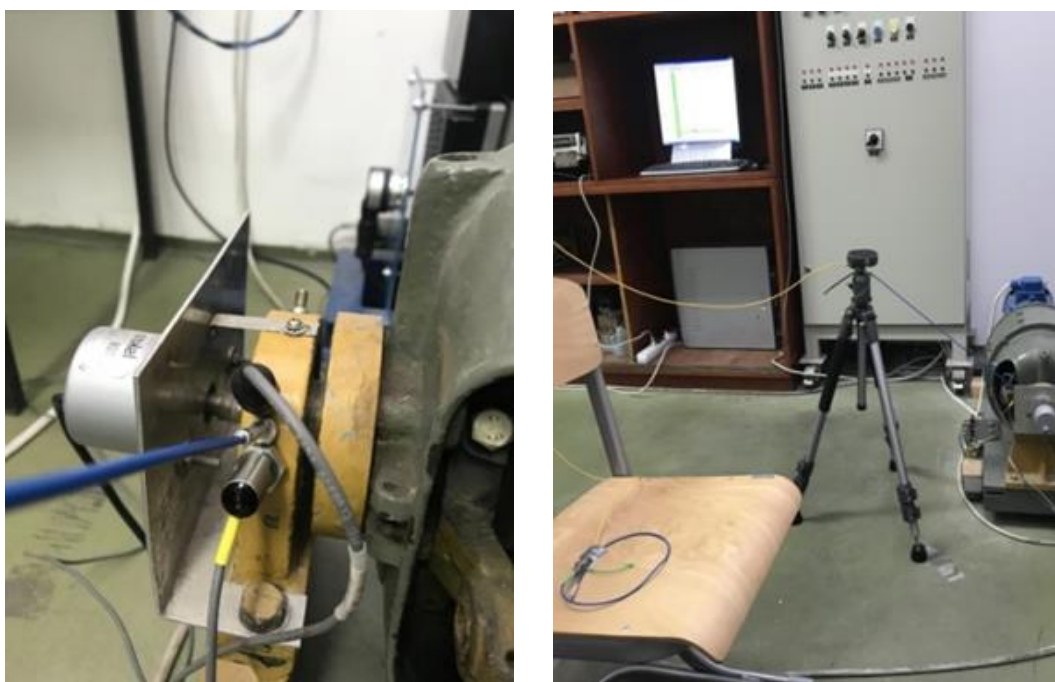
Slika 6.3 Prikaz položaja mjerne i referentne petlje pri mjerenju u laboratoriju na FESB-u
