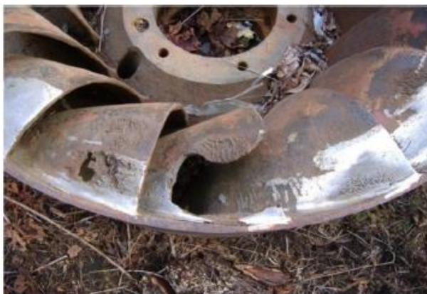
Slika 2.2 Oštećenja uslijed kavitacije [1]
