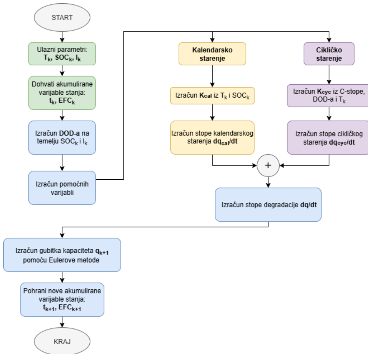
Slika 3.4: Dijagram toka modela degradacije baterije
