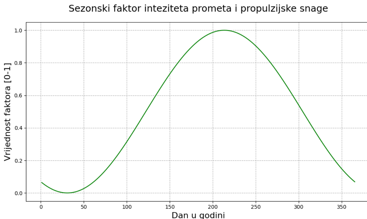
Slika 5.2: Prikaz promjene sezonskog faktora intenziteta prometa i propulzijske snage
