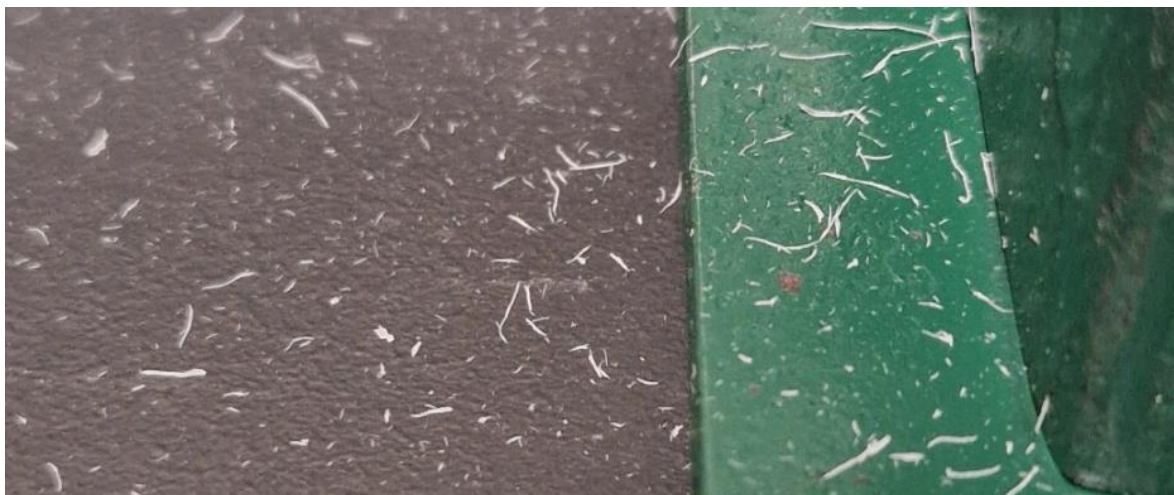
Slika 4.8 Odvojene čestice (krhotine) u fazi uhodavanja
