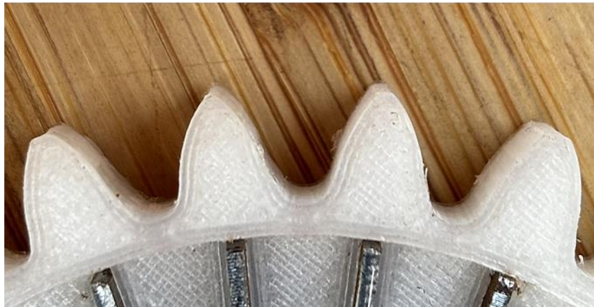
Slika 4.22 Trošenje boka zuba gonjenog hibridnog zupčanika s (a) aluminijskim i (b) čeličnim umecima
