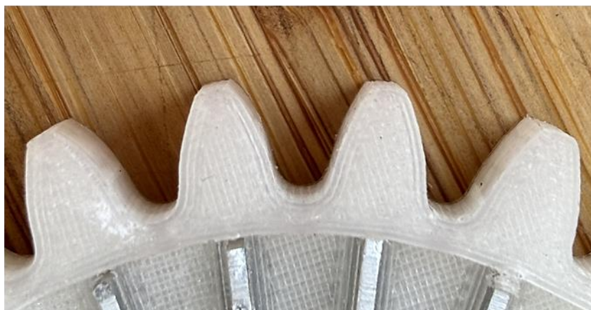
Slika 4.33 Trošenje boka zuba gonjenog (a) polimernog i (b) hibridnog zupčanika
