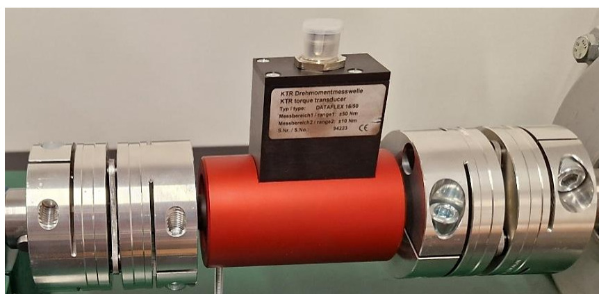
Slika 3.3 Uređaj za mjerenje okretnog momenta i brzine vrtnje s pripadajućim spojka [90]
