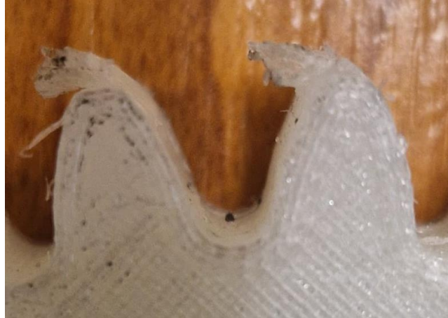
Slika 4.10 Gomilanje polimernog materijala na vrhu zuba zupčanika
