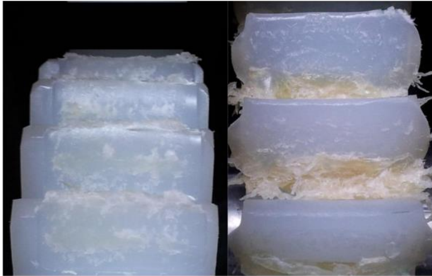
Slika 1.6 Stanje površine boka zuba pogonskog i gonjenog PA 6 zupčanika sa zasićenosti vlagom od 100 % [21]
