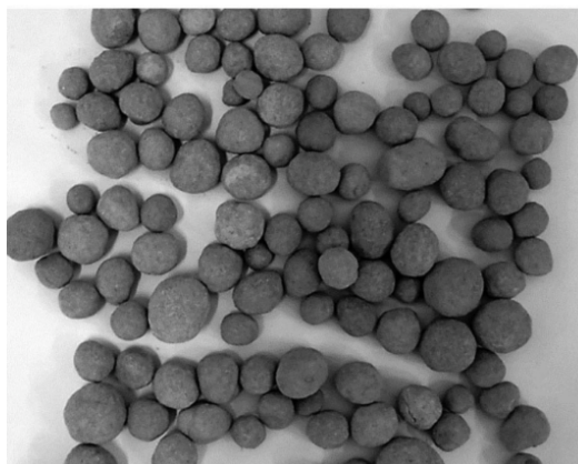
Slika 5.3. Agregati peleta nakon procesa stvrđavanja [51]
