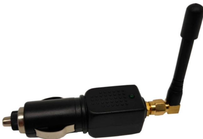
Slika 3-2 Ilegalni automobilski ometač. [31]
